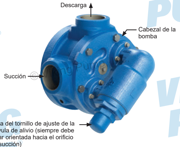
FIGURA A5-A: VÁLVULA DE ALIVIO DE PRESIÓN INTERNA
