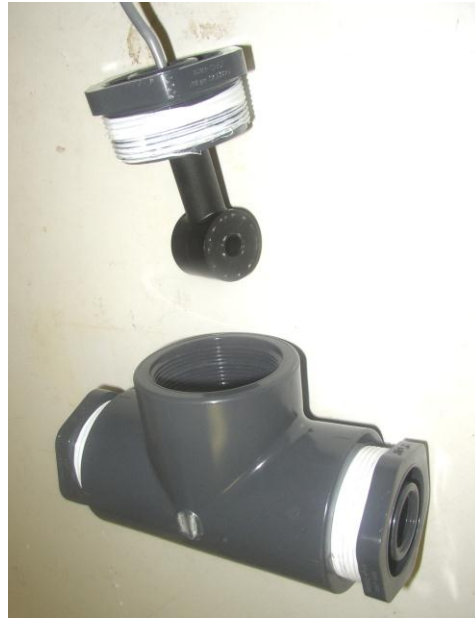
Sondă de conductivitate cu T Fig. 7
